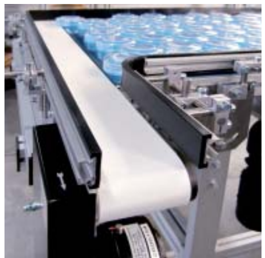
GUF-P 2000 als dwarstransportband en uitdunner na een afkoelingstraject
