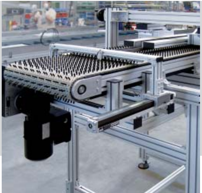
MBF-P 2040.02 met borstels voor krasgevoelig plaatmateriaal
