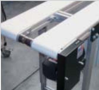
Aandrijving van twee transportbanden met een motor in kopaandrijving
