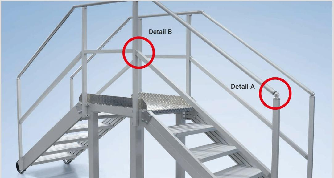
Dieser Treppenübergang ist eine typische Lösung, um Übergänge über Transportstrecken zu schaffen, z.B. als Brandschutzlösung. Das Trittbloch auf dem Podest ist nach oben gekantet, damit kein Dreck vom Betreten herunterfallen kann. In dieser Anwendung wird der Übergang in einem technisch sauberem Bereich eingesetzt. Daher wurden die Außenflächen mit geschlossenen Reinraumprofilen gestaltet, um hier offene Spalten zu vermeiden.
