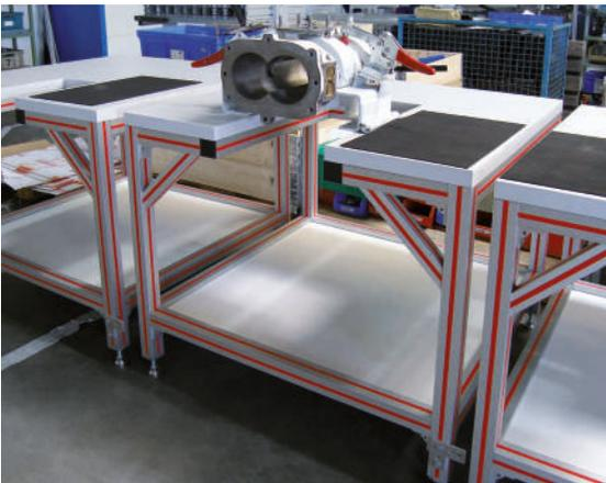
Montagelinie für Pumpen aus Profilsérie 50 mit geschlossenen Profilmuten über Verschlussprofil rot
