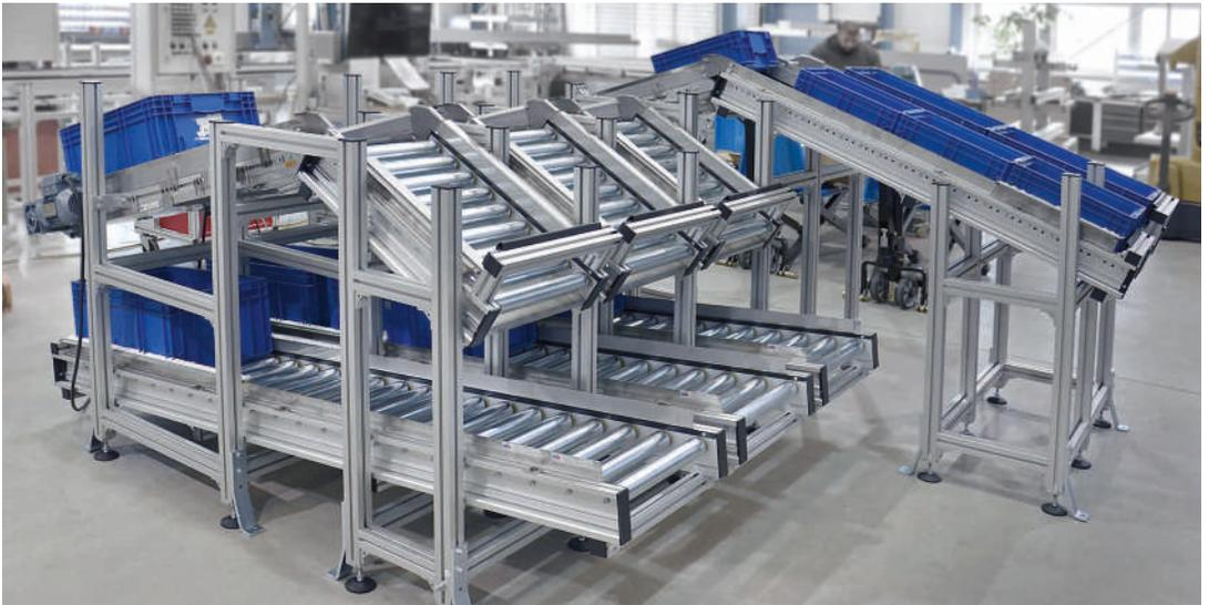
ESD-konforme Belade- und Entnahmestation
