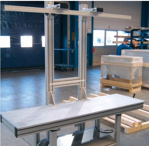
Montagearbeitsplatz manuell höhenverstellbar über Handkurbel, Belastung 600 kg
