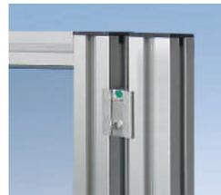
■ In den Haltern integrierte Gewindestifte festziehen und Feld dadurch verriegeln. Bei Verwendung der Halter, unverlierbar, fällt das Abdeckblech in seine untere Halteposition, verdeckt dabei die rote Farbmarkierung und gibt die grüne frei. So ist jederzeit erkennbar, ob das Schutzfeld gesichert ist.
