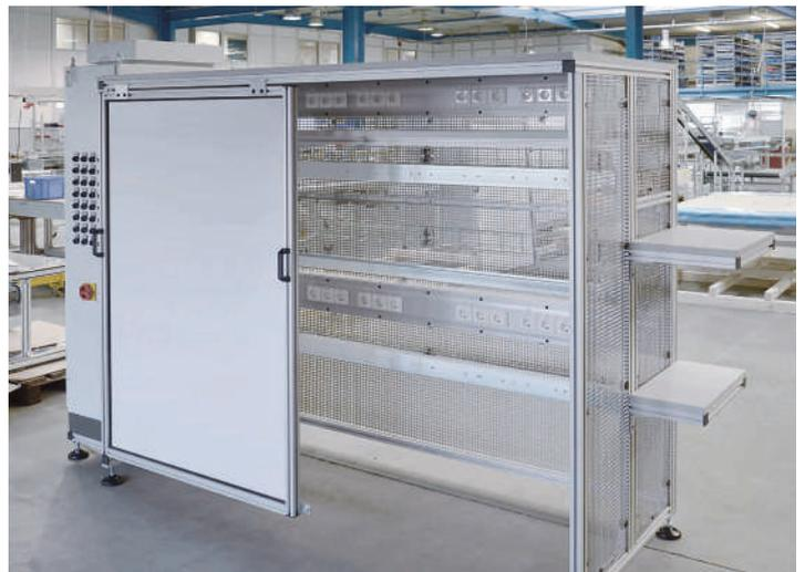
Prüfstand für Pumpen mit Lochblechfüllung,
