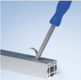
Zum Austrennen, bzw. Freilegen der Nuten (10 mm) bei Reinraumprofilen.
