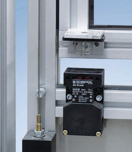
Bei den Sicherheitsschaltern sind Schaltglied und Betätiger nicht konstruktiv miteinander verbunden, werden jedoch beim Schalten funktionell zusammengeführt oder getrennt. Beim Öffnen der Schutzvorrichtung wird der Betätiger vom Grundgerät getrennt. Dabei werden im Sicherheitsschalter die Öffnerkontakte zwangsläufig geöffnet und Schließerkontakte geschlossen.
