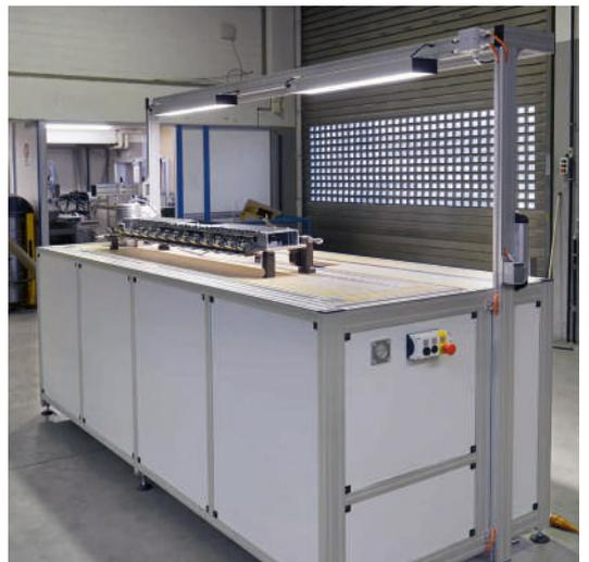
Montagearbeitsplatz mit Absenkvorrichtung über elektrisch angetriebene Hydraulikzylinder
