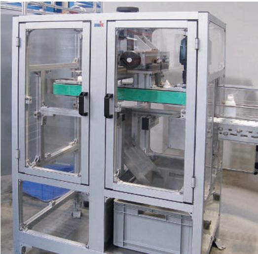
Schutzeinrichtung mit Flügeltüren aus Reinraumprofilen
