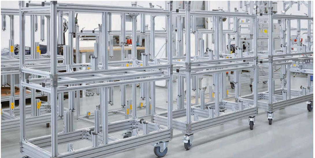
Prüf- und Lagergestelle für Kraftstofftanks aus Profilsreihe 40
