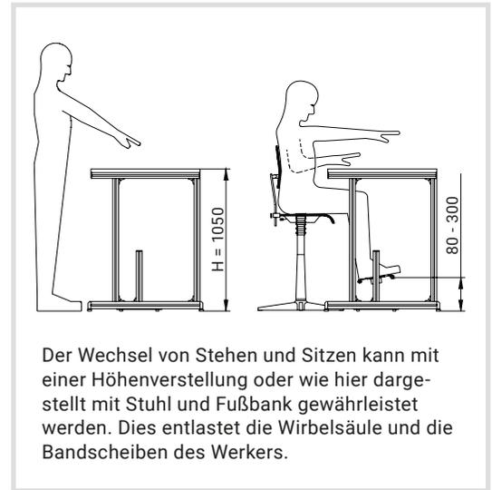
Der Wechsel von Stehen und Sitzen kann mit einer Höhenverstellung oder wie hier dargestellt mit Stuhl und Fußbank gewährleistet werden. Dies entlastet die Wirbelsäule und die Bandscheiben des Werkers.
