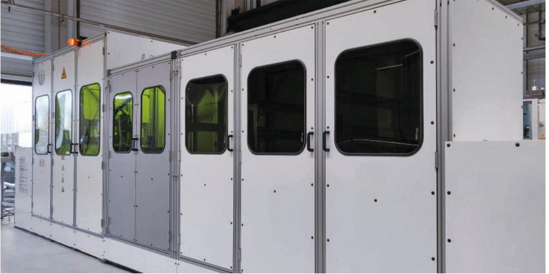
Laserschutzkabine mit Labyrinth-Dichtungen für Automatisierungslinie
