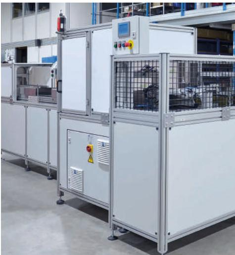
Schutzeinhausung mit verriegelter Schwenktüre zur Kontroll-Entnahme des Bauteils
