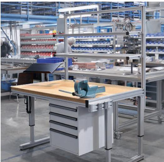
Arbeitsplatz mit elektro-hydraulischer Höhenverstellung und Unterbauschrank
