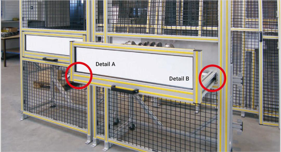
Schutzumhausung einer Vermessstation für Kurbelwellen in Feldbauweise mit Schweißgitter. Die vorderen Felder wurden mit einer Schublade mit Vollauszug zur manuellen Entnahme ausgerüstet. Dabei verschließt die hintere Seite den Schutzbereich so, dass der automatisierte Prozess während der Entnahme nicht unterbrochen werden muss.
