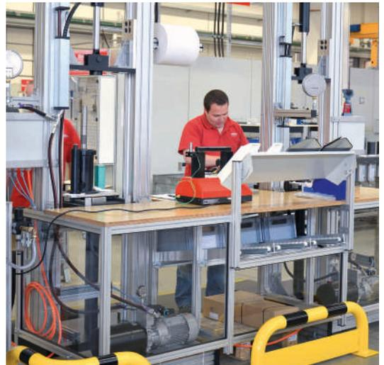
Montagearbeitsplatz mit integrierter Presse und Dokumentenablage
