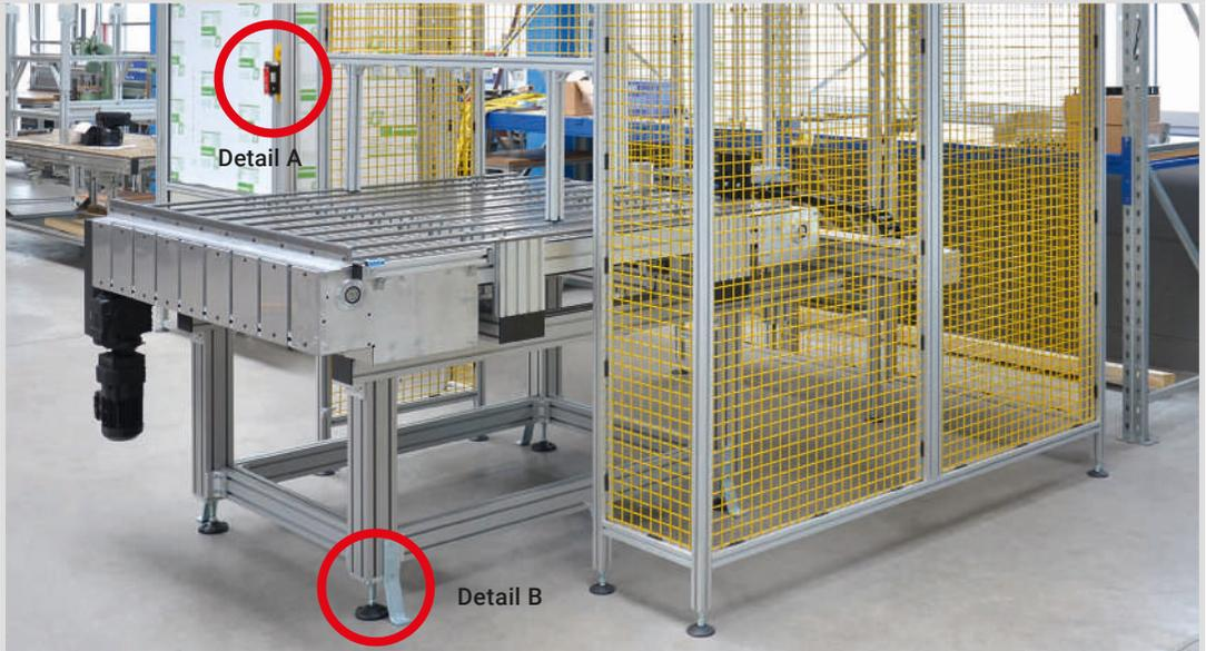
Die Greif- und Übergabestation der Anlage wird durch umlaufende Feldrahmen mit Schweißgitter im kundenspezifischen RAL-Ton geschützt. Der Einlauf und die Messzelle werden durch Feldrahmen mit Polycarbonat und Verkleidungsblech geschützt. Neben der Flügeltür wurde auch eine platzsparende Falttür eingebaut.
