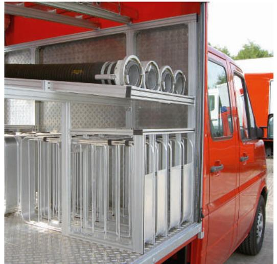
Innenausbau für Feuerwehrfahrzeug aus Profilen der Serie 25
