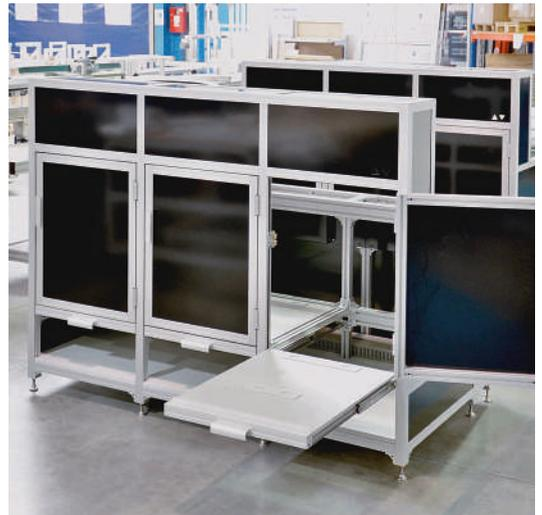
Cabinet mit Flügeltüren und ausziehbaren Einlegeböden
