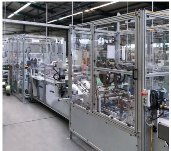
Retrofitting einer Produktionslinie mit Schutzeinhausungen
