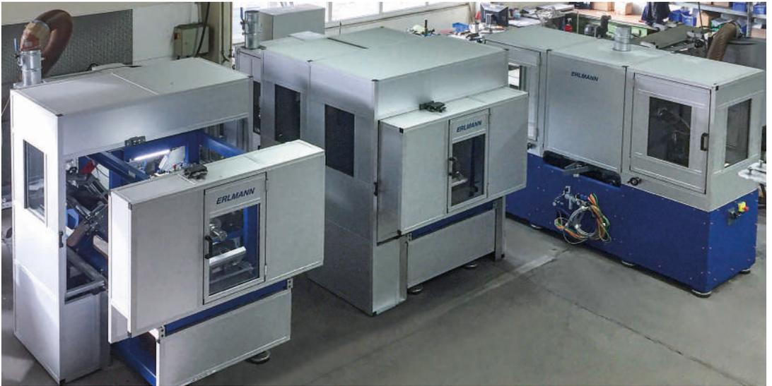
Ausziehbare Schutzeinrichtungselemente, auf Rollen gelagerte Teilstücke lassen sich manuell über den ersten Teil fahren
