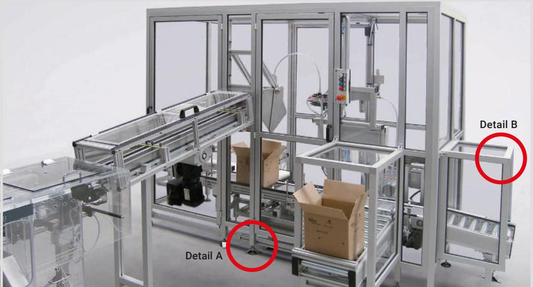
Schutzumhausung für Anwendungen in der Kosmetikindustrie. Aufgrund der hohen Hygieneanforderungen wurde die Maschinenumhausung aus Reinraumprofilen der Serie 40 mit verschlossenen Profilmuten gebaut. Um einen freien Blick auf die Verpackungsstation zu haben wurde das Flächenmaterial in kratzfestem Makrolon ausgeführt. Außerdem wurden Edelstahlstellfüße eingesetzt, die für die Einsatzbedingungen unter den geforderten Hygienevorschriften ideal sind.
