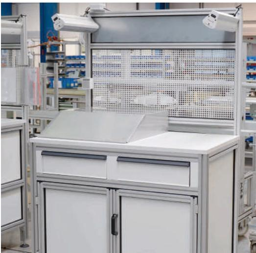
Prüfplatz aus Profilsérie 50, Unterbauschrank mit Schubladen und Flügeltür, Portalaufbau mit Stahlblech und Lochblechfüllung
