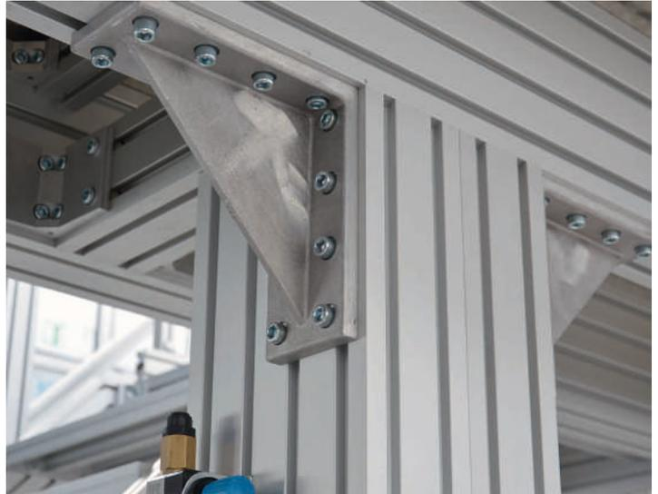
Sehr stabile Verbindung mittels Gusskonsole, Konsolen
