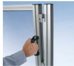
■ Untere Halter auf untere Bolzen aufsetzen. Dazu Feld leicht neigen.
