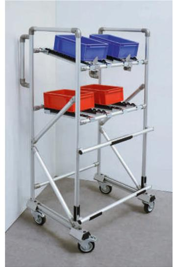
Materialbereitstellung nach Kanban-Prinzip über Röllchenleisten
