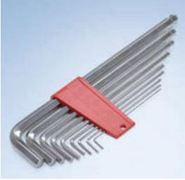
Die Kugelseite dient dem schnellen und einfachen Andrehen der Schraube. Beim Festziehen sorgt die lange Schlüsselseite für das richtige Anzugsmoment. Die Schlüssel sind aus hochwertigem Chrom-Vanadium-Stahl gefertigt.
