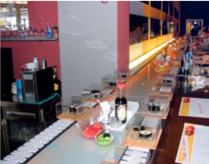
Transportadores de charnelas mk INOX para Running-Sushi Bar
