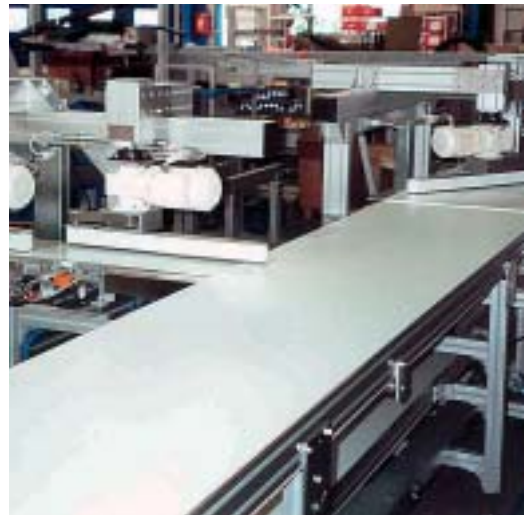
Tramo de clasificación y embalaje para chocolates y bombones
