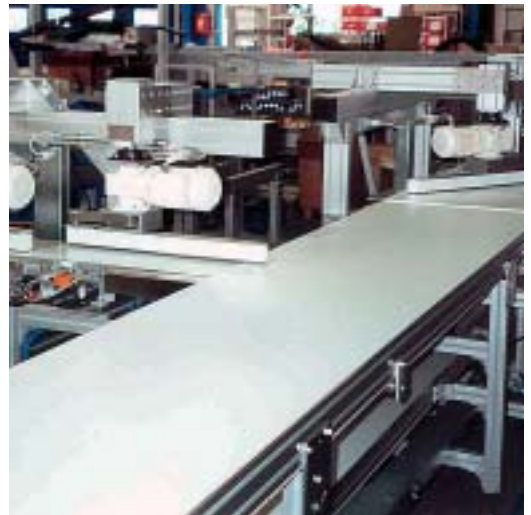
Sortier- und Verpackungsstrecke für Schokoladen - Pralinen
