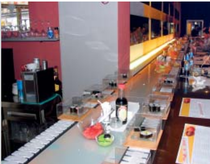
mk INOX Scharnierbandförderer für Running-Sushi Bar
