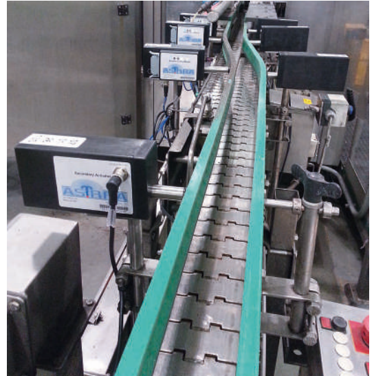
Transportador de acero inoxidable Versaflex SBF con guía lateral de ajuste automático ASTRA
