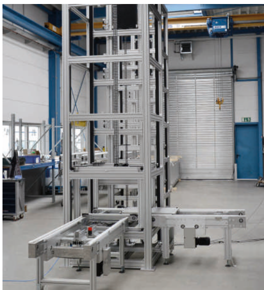
Elevador con acceso desde tres lados, con corona giratoria en cesta de transporte y alimentación mediante Versamove ultra
