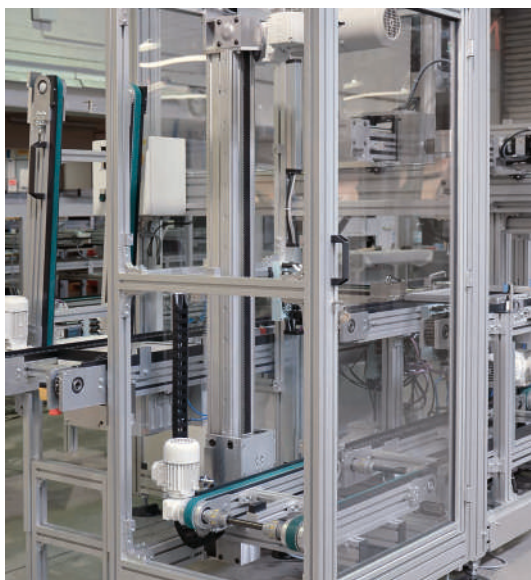
Elevador de accionamiento eléctrico en soporte "Stand alone" con dispositivo de protección
