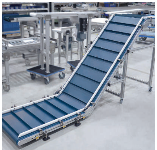
KFG-P 2000 ECO con listón deslizante conforme FDA como guías laterales
