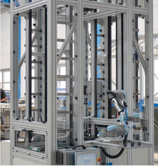
Sistema de almacenamiento de carrera para palets portapiezas con dos transportadores de cadena de movimiento contrario y entradas de PP
