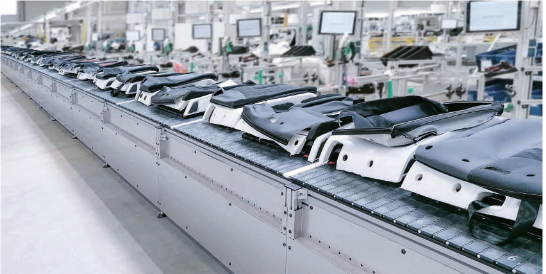
MBF-P 2040 de 42 metros de longitud, con protección lateral contra zonas ciegas y guardamano, para el montaje «just-in-sequence» en la banda transportadora en marcha
