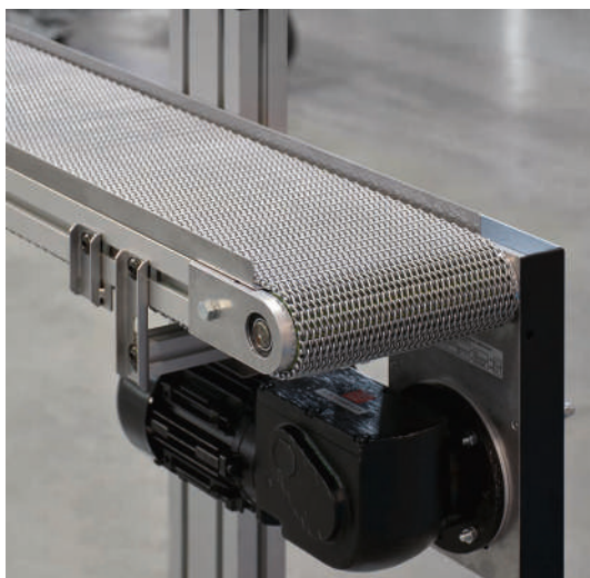
GU-F-P 2000 con accionamiento delantero AC con correa de alambres redondos para producto a transportar hasta 150°C
