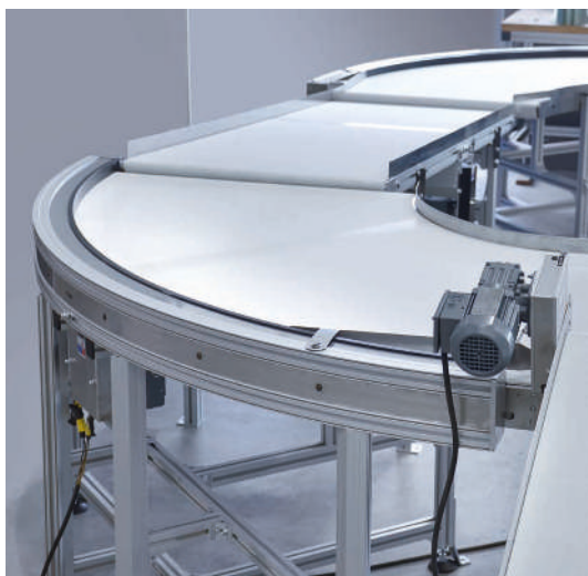
Combinación de dos transportadores de banda KGF-P 2040 en curva de 90° con accionamiento inferior BI, reversible
