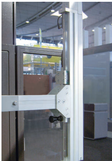
VST 2015 electromotorizado con guía de recirculación de bolas
