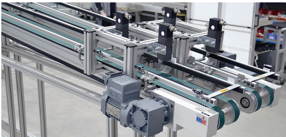
Transportador de correa dentada doble de dos vías ZRF-P 2040 con unidad de separación e inclinación ajustable
