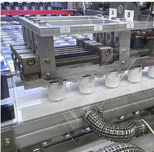
Transportador de banda de vacío para el transporte rápido y sincronizado de copas de plástico
