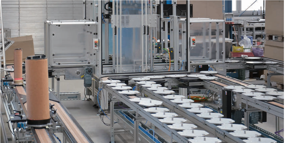
Encadenamiento automatizado con palets portapiezas incl. giro, parada, separación y centraje basado en transportadores de charnelas
