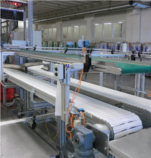
Versaflex SBF A29 como mesa de embalaje en combinación con transportador de banda en el segundo nivel
