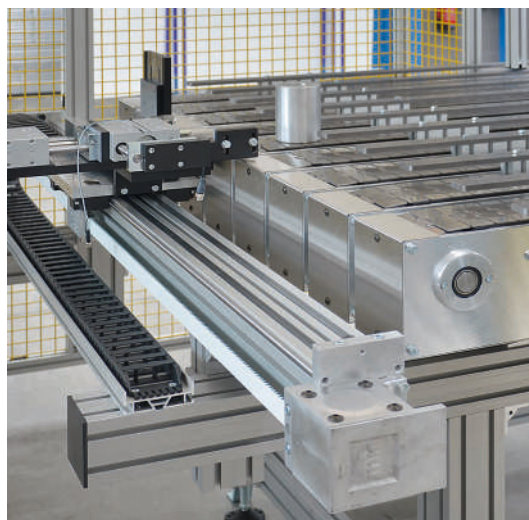
Eje lineal de módulo lineal LZR 2005-38.44-30 con sistema de agarre y entrega desplazable
