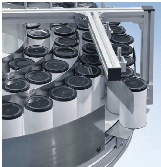
Mesa de giro DT-P 2040 con expulsor y posicionamiento mediante chapas laterales perimetrales
