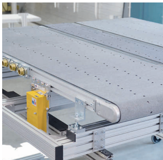
GUF-P 2041 en versión especial como transportador de vacío para placas de impresión offset
