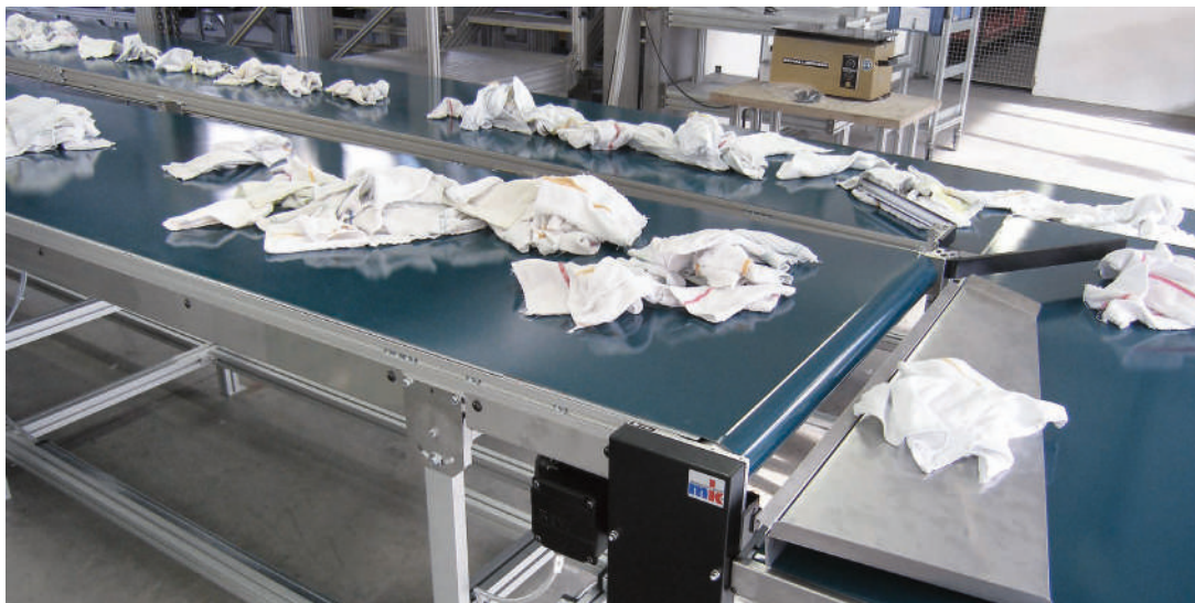
Sistema circulante para ordenar manualmente ropa en base a transportadores GUF-P 2041 y GUF-P 2000 con accionamiento delantero AC
