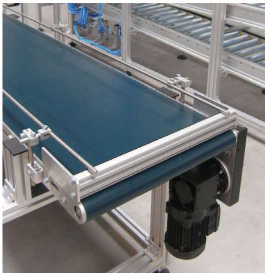
Transportador de banda GUF-P 2000 AC con acumulador al final de la banda
