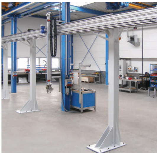
Pórtico X-Z con pinzas para el traslado de cigüeñales. Eje X como LZR con rodillo de apoyo y correa dentada, eje Z con accionamiento Omega de correa dentada y protección anticaída.
