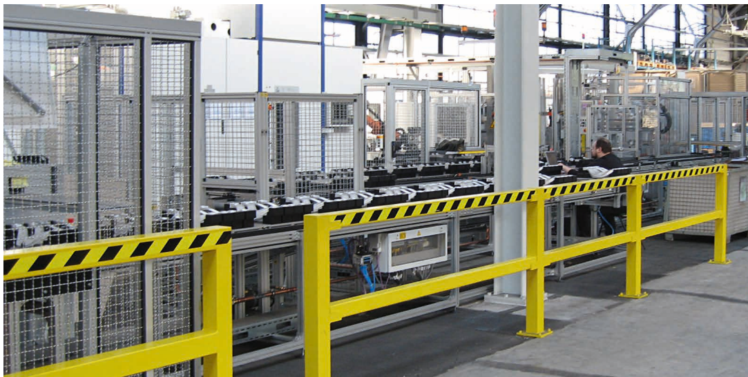
Encadenamiento de celdas de producción en el sector de la automoción. Equipamiento manual de PP, retirada con sistema de manipulación de piezas y robot del cliente. Nivel inferior de retorno con elevador y shuttle.
