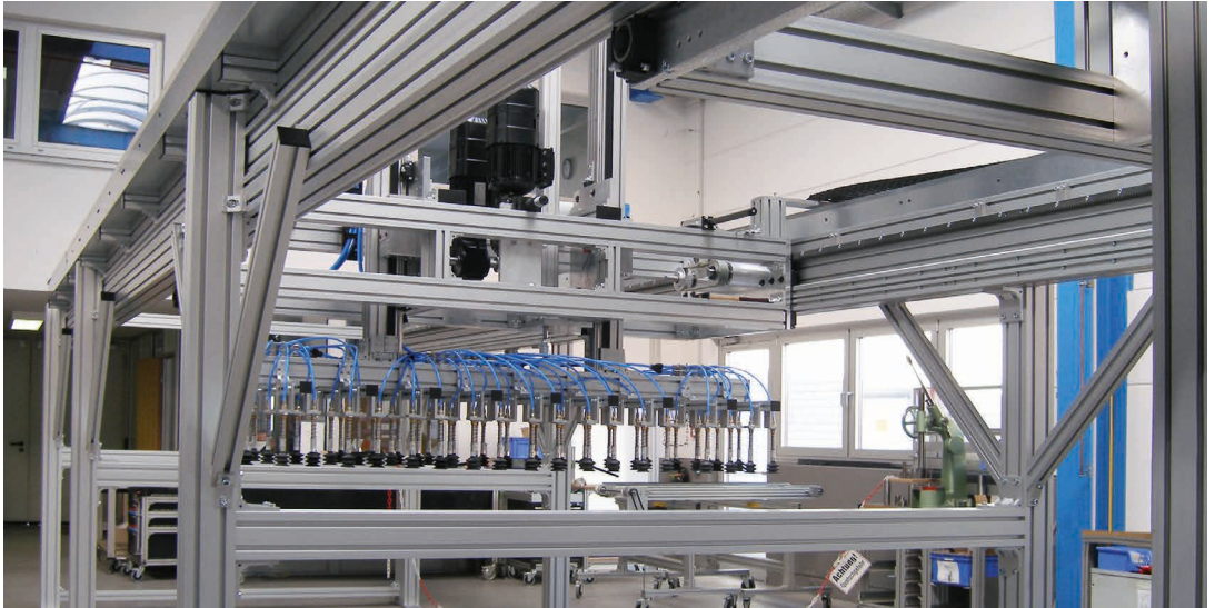
Pórtico X-Z con pinzas de vacío como sistema de carga y manipulación de chapas de acero. Dos sistemas de carga independientes en un eje X común con cremallera, con rodillos y accionamiento por arrastre de barra dentada
