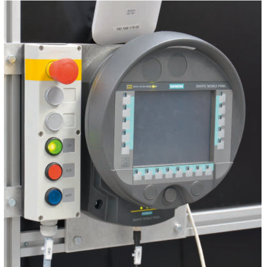
Cuadro de mandos en la puerta con botón de parada de emergencia y panel de mando móvil
