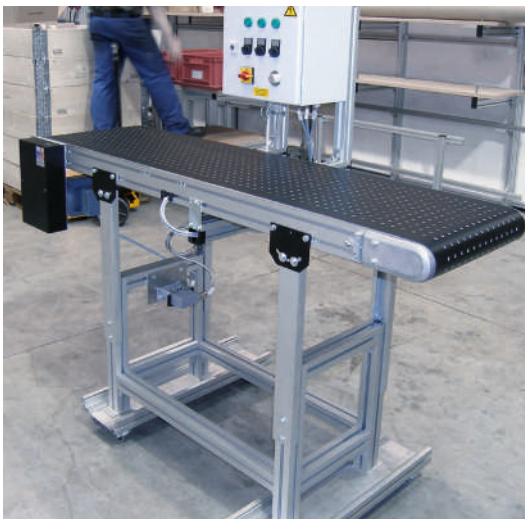
GUF-P 2041 con accionamiento delantero AC y ventiladores de 90 vatios en el cuerpo de banda, Reglomat arriba en el cuerpo de banda
