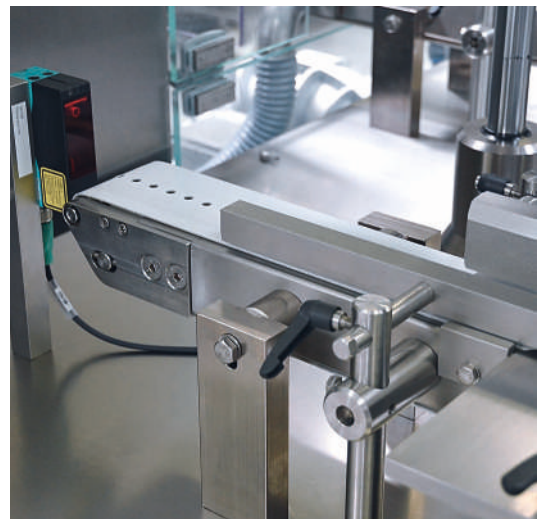
Transportador de banda de vacío INOX con guías laterales individuales
