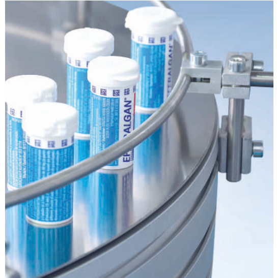
Mesa de giro DT-P 2040 con guías laterales similares a SF01
