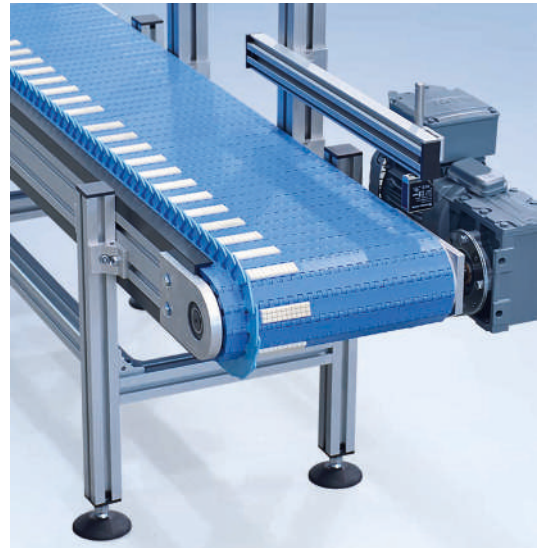
Transportador de banda modular MBF-P 2040 con cadena de banda modular con parte superior de goma (a un lado)
