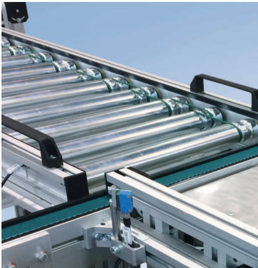
Camino de rodillos motorizados RBM-P 2255 como acceso de mantenimiento
