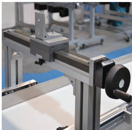
Sistema de 2 ejes manual para el alojamiento de un dispositivo de marcado con VST 2015
