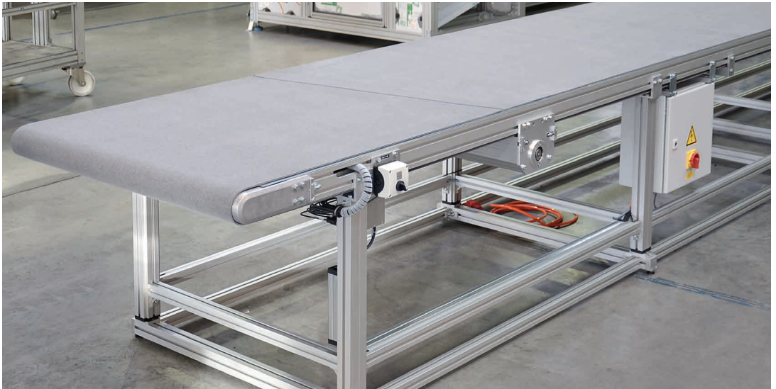
GUF-P 2041 con accionamiento inferior BC, se puede ajustar la altura del soporte mediante una bomba hidráulica
