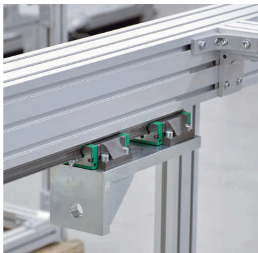
Soporte para ensayos de pandeo con guía de recirculación de bolas KU 30.10
