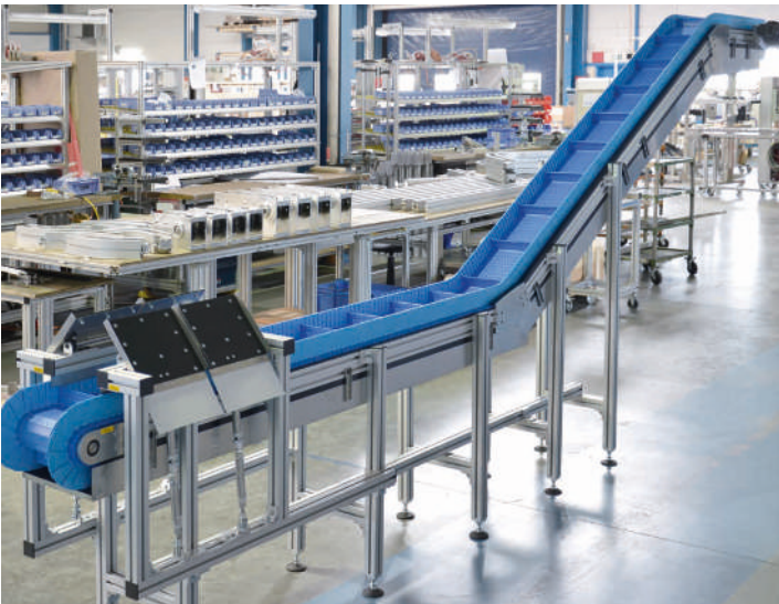
KFM-P 2040 con bandeja recogedora y clapeta de expulsión
