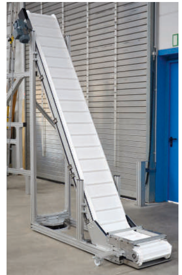
KFM-P 2040 abatible con punto de giro fijo, ruedas maniobrables y pestillo de fijación
