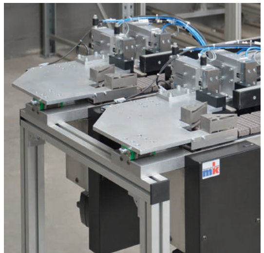
Alimentación de dos vías para la carga de la máquina El ajuste de la separación para diámetros distintos se realiza mediante una guía de recirculación de bolas
