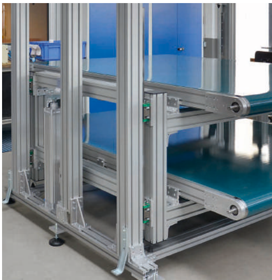
Estación elevadora para la elevación o descenso de los transportadores en dos niveles de transporte. Unidad de desplazamiento transversal con guías de recirculación de bolas horizontal en soporte
