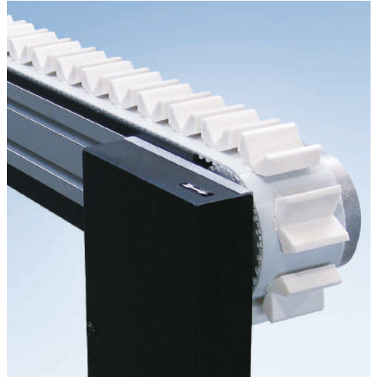
Transportador de correa dentada ZRF-P 2040 con accionamiento AC y prismas pegados para el alojamiento de barras
