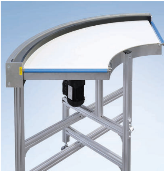
Transportador de banda en curva KGF-P 2040 con rodillos para la transferencia al transportador de banda sin canto de cuchilla
