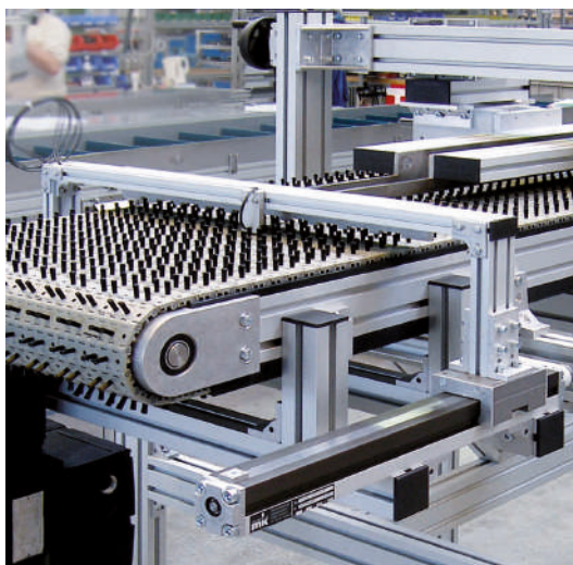
Transportador de banda modular MBF-P 2040 con accionamiento delantero AC y cepillos de plástico para un transporte cuidadoso
