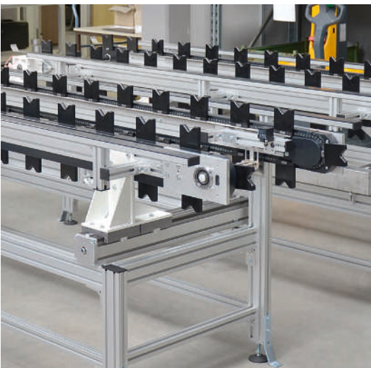
TKU 2040 con unidad de ajuste especial para ajustar la distancia entre las vías transportadoras
