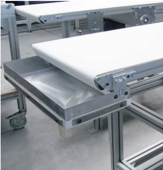
Transportador de banda con saco de recolección de polvo
