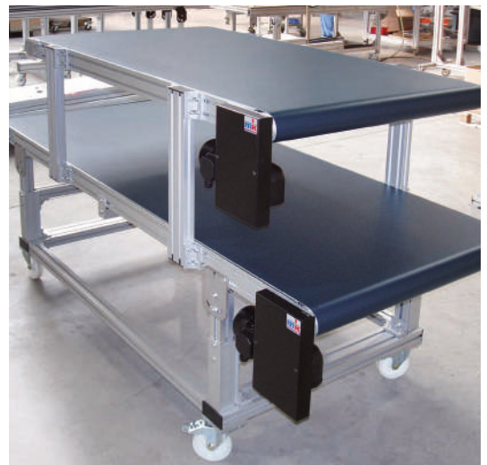
Dos GUF-P 2041 en combinación de tándem con sistema de bastidores desplazables para la doble alimentación móvil de una planta
