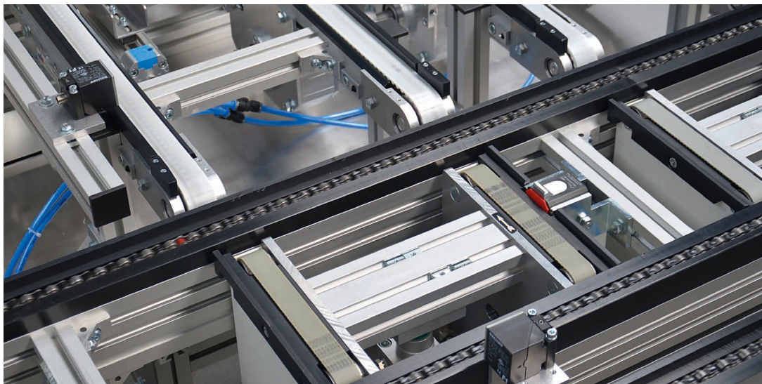
Expulsión de PPs de la línea principal en dos tramos paralelos de transporte transversal
