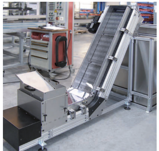
KFS-P 2040.86 para productos calientes con reservorio de entrada de tamaño adaptable
