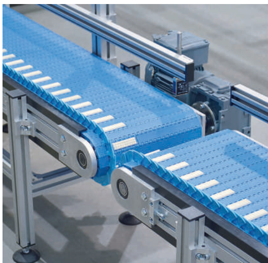
Encadenamiento MBF-P 2040 con guías y limitaciones laterales unilaterales para sostener el producto
