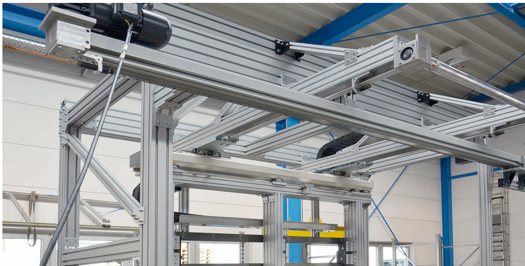
Pórtico de dos ejes para la manipulación de manguitos con ventosas paralelas
