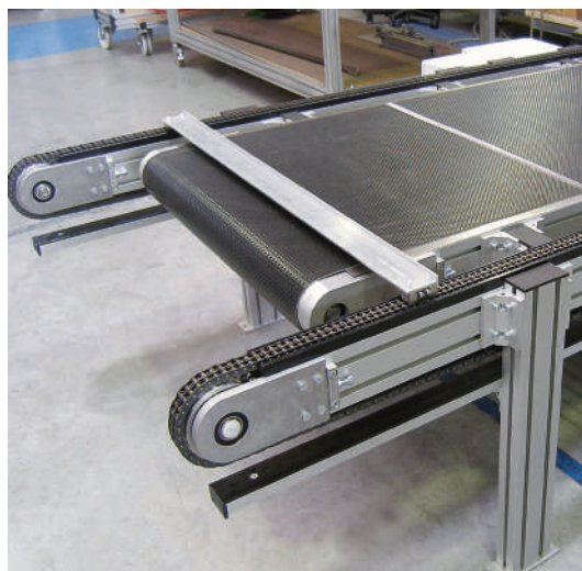
Combinación de transportador de cadenas y de banda con guía transversal para simular un obstáculo en el suelo
