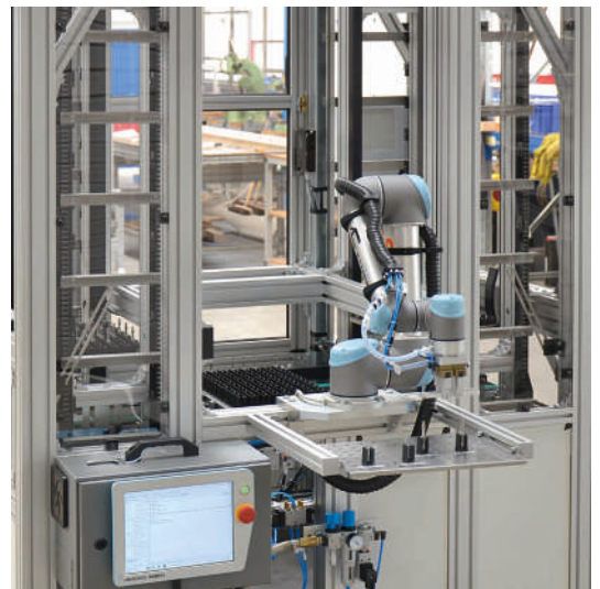
Celda de mecanización con almacenamiento paternóster doble para piezas de entrada y de salida
