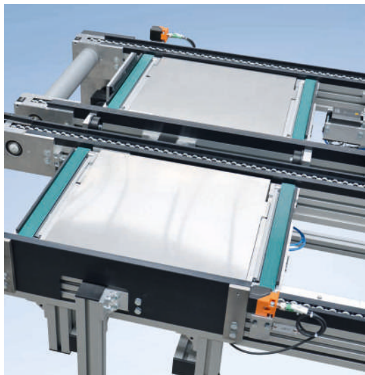
Transportador de cadena de rodillos de acumulación SRF-P 2010 como sistema circulante de PPs con transportador transversal elevador
