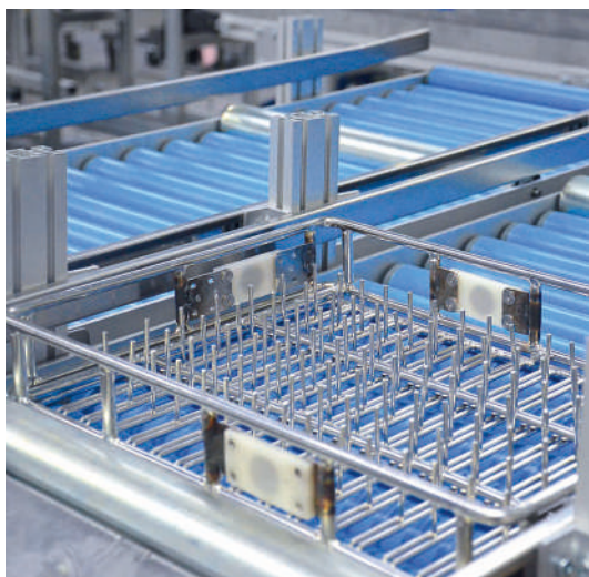
Camino de rodillos de gravedad RBS-P 2065 como vía de acceso y de salida para cestas de lavado
