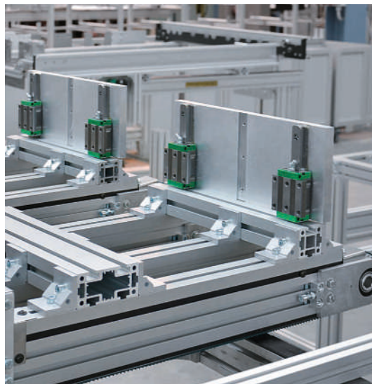
Unidad elevadora con guía de recirculación de bolas KU 25 y consola
