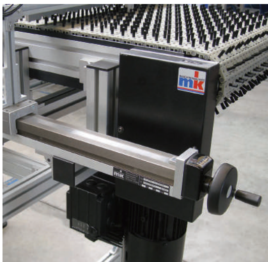
VST 2015 doble con indicación digital manual para el ajuste del listón de tope
