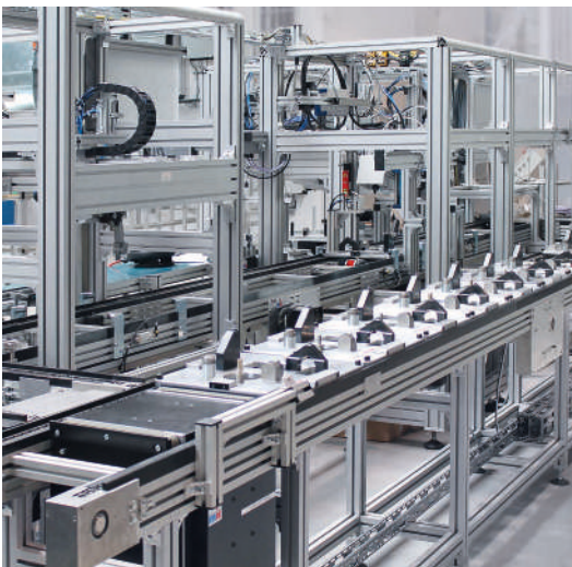
Sistema de palets portapiezas Versamove plus con automatización de montaje llave en mano
