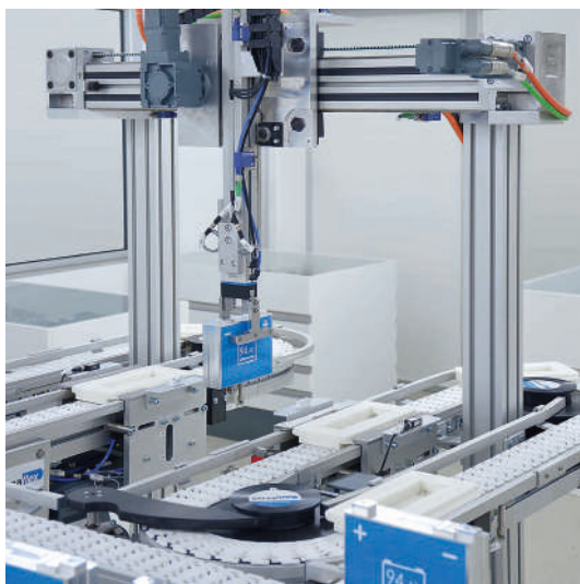
Pórtico de dos ejes con servomotores y ventosa individual en combinación con transportador de charnelas Versaflex
