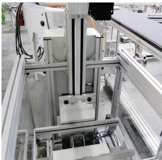
Módulo lineal tipo LZR 2005-38.44-30 con motor y control como elevador con transportador de banda
