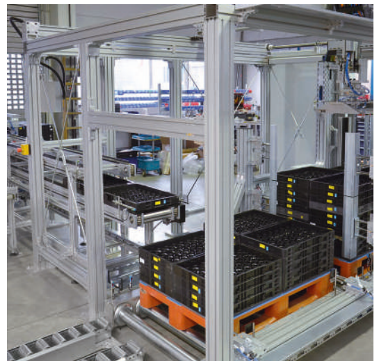
Pórtico X-Y-Z para el desapilado o apilado de palets Gob a eur opalets
