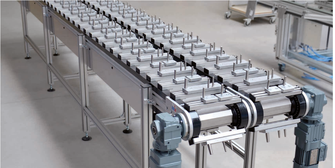
TKU como sistema de dos vías con PPs de perfil y entradas específicos del pedido
