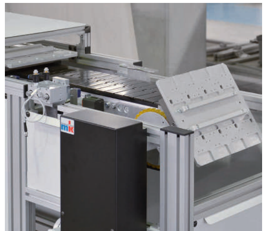
SPU de una vía con alojamiento de palets portapiezas específico del cliente
