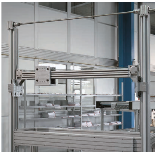
Módulo lineal de 2 ejes LZR 2011-38.44.30 con carro de rodillos lateral
