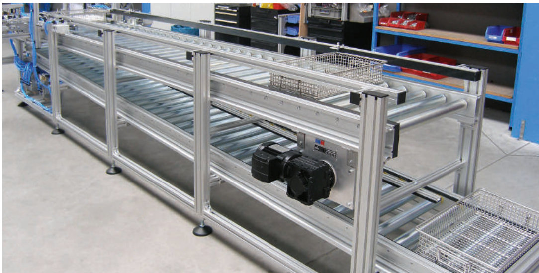
Transportador de rodillos de fricción RBT-P 2255 con transportador basculante como función elevadora para el retorno de las cestas vacías
