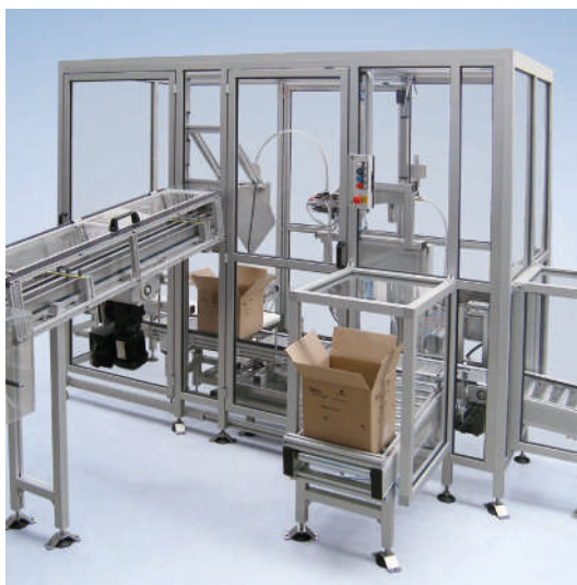
Instalación para llenado de cartones con encadenamiento de la estación de llenado de tubos antepuesta e integración de la balanza suministrada con expulsión de piezas NOK
