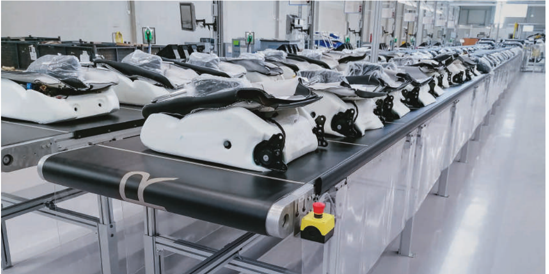
GUF-P 2004 de 45 metros de longitud como línea de alimentación en la producción «just-in-sequence» de asientos de automóviles
