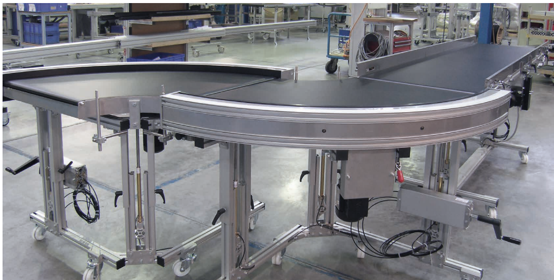
KGF-P 2040 con accionamiento inferior BI y ajuste hidráulico de altura de los bastidores mediante manivela
