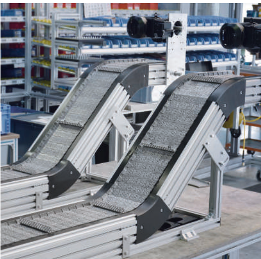
KFS-P 2040.86 accionamiento delantero AC con cadena de banda de charnelas perforada, tacos transversales y botones para un mejor arrastre de producto
