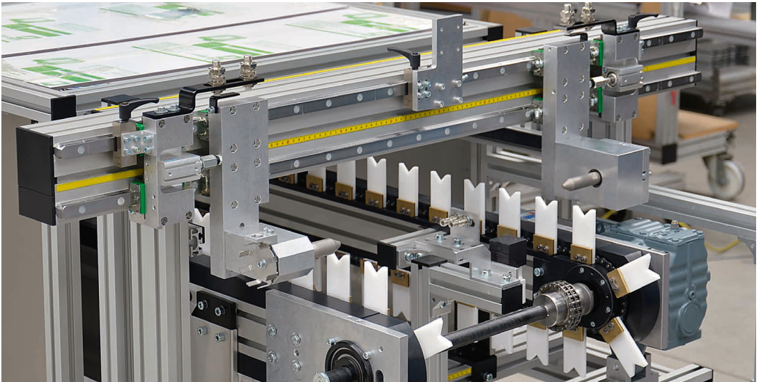
Transportador de cadena por impulsos con unidad de alineación mediante guía de recirculación de bolas
