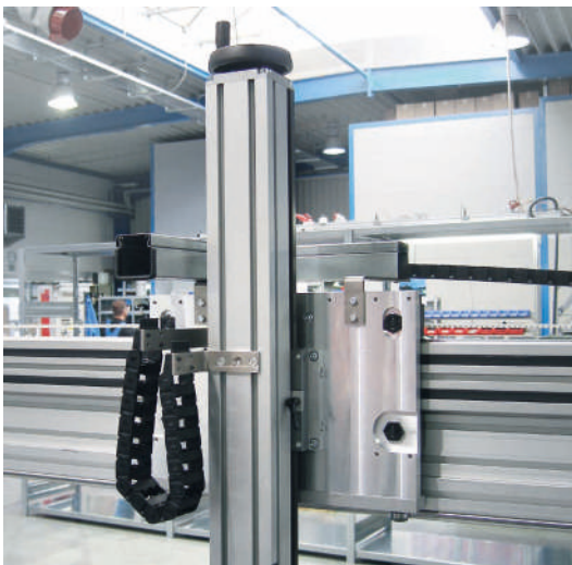
Base LZR 2005-38.44-30 con carro de rodillos lateral sobre perfil combinado espumado como pórtico, con rodillos de apoyo para absorción de pares y VST 2011 manual como eje Z
