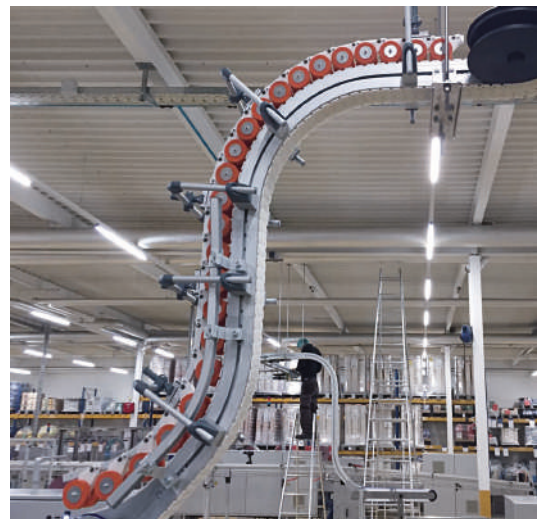
Versaflex SBF con rodillos de presión para el transporte vertical
