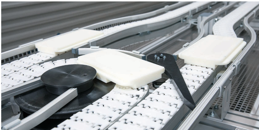
Sistema de palets portapiezas basado en SBF Versaflex A08 con aguja
