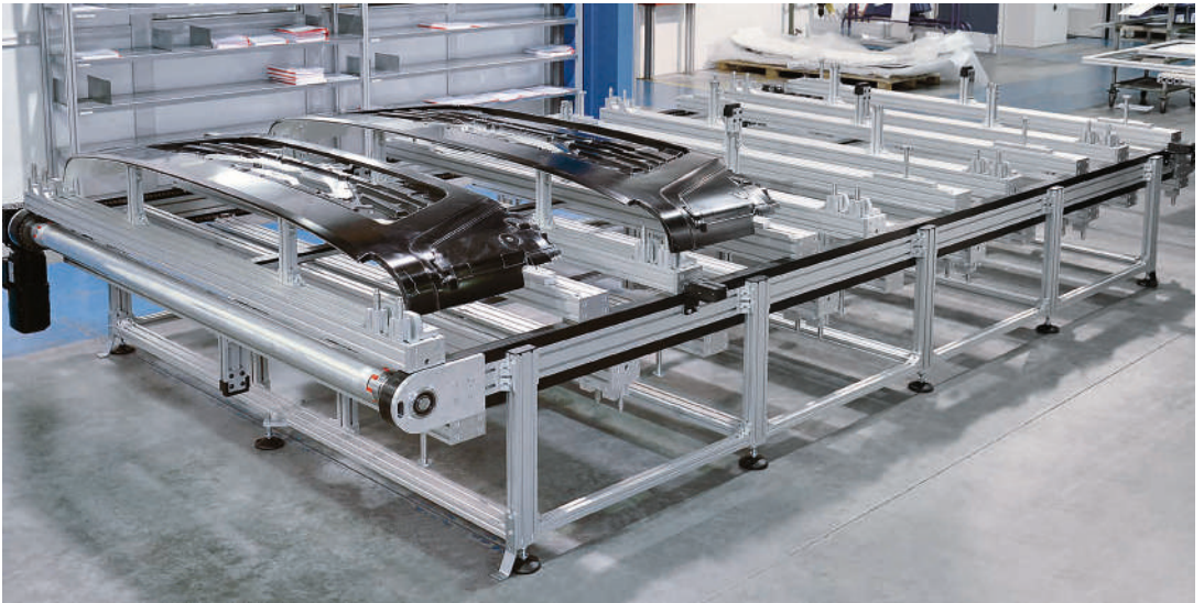
Sistema de circulación de cadena compatible con ciclos TKU 2040 con alojamiento de piezas individual y centraje para el sector de la automoción
