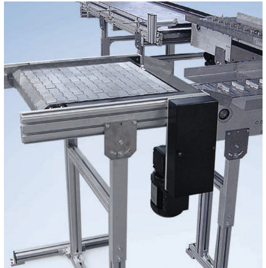
Transportador de banda modular corto MBF-P 2040.86
