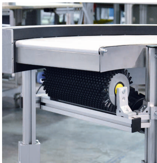
Cepillo rascador, rotatorio, montado en el extremo de la banda
