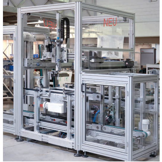
Circulación de PP para diferentes niveles de transporte con pórtico de 3 ejes
