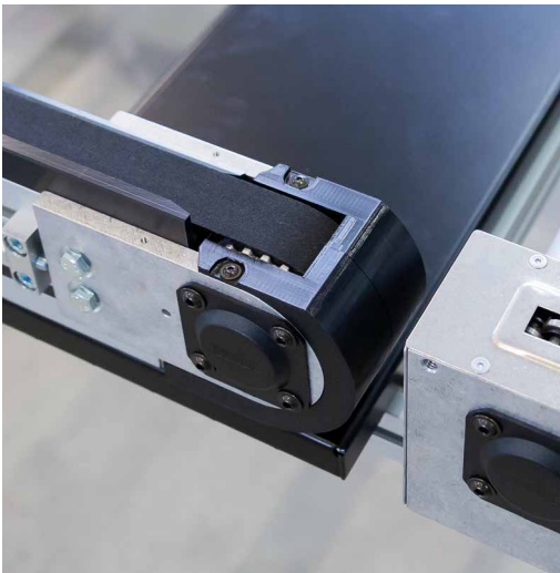
Eingreifschutz für Öffnung an Umlenkung von Zahnriemenförderer
