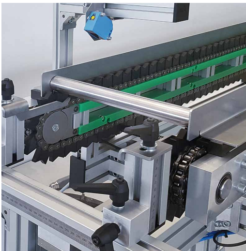
Kettentaktband mit Mitnehmern aus dem 3D-Druck
