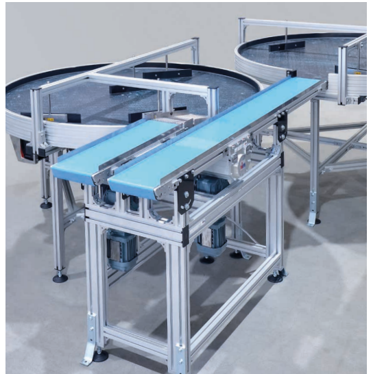
Drehtisch mit gefräster Sonder-Kunststoff-Gleitplatte und Zuführung über Gurtförderer
