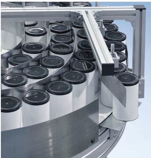
Drehtisch DT-P 2040 mit Ausschleusung und Positionierung über umlaufende Seitenbleche
