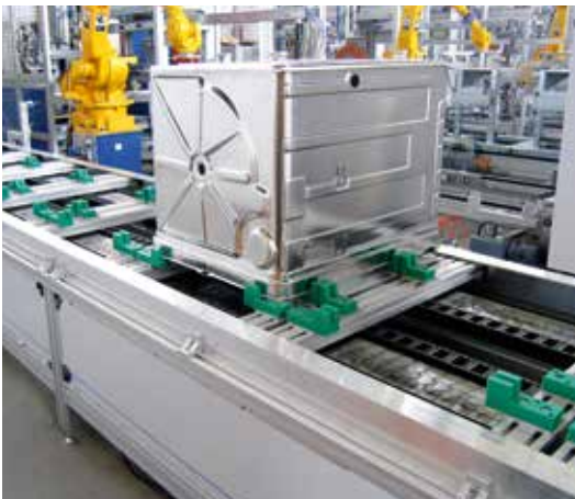
SPU Doppelstrang als Zuführband für Spülmaschinegehäuse
