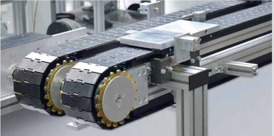
SPU Zweistrang 114er System mit Vereinzelfunktion als Teilezuführung für eine Produktionsanlage
