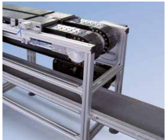
SPU Zweistrang mit Gurtförderer GUF-P 2000 als Abführband für n.i.O Teile
