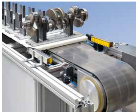
SPU mit Sonderkette und seitlicher Positionierung über Röllchenleiste
