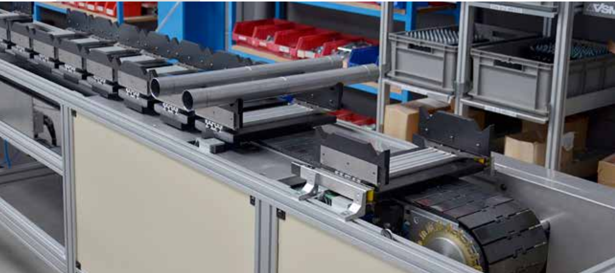
Staufähiges Palettenumlaufsystem SPU mit WT-Vereinzelungsfunktion als Teilezuführung für eine Produktionsanlage
