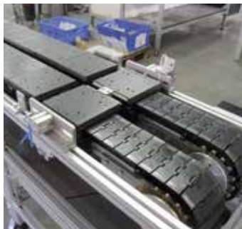
Zentriereinheit zur exakten Positionierung der Werkstückträger
