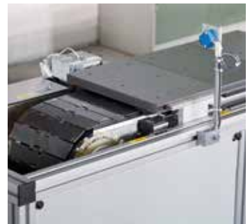
SPU mit Vereinzelungsfunktion zur manuellen Entnahme während des Dauerbetriebs
