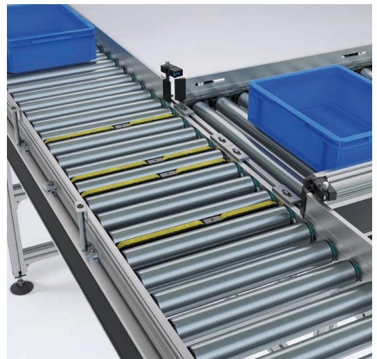
Convoyeur à rouleaux RBF 2000 avec module de transfert à 90° pour l'éjection de produits convoyés à angle droit
